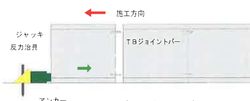
ジャッキによる押し込み (コーキング工法は不要)
