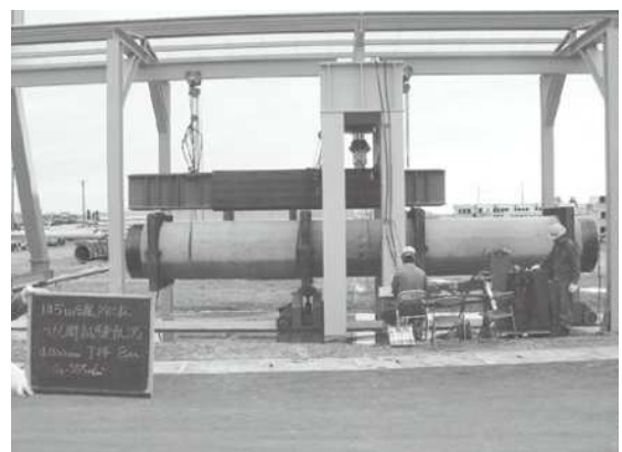
φ1000mm (I種) せん断実験の全景
