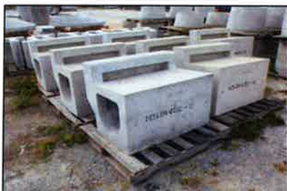
集水樹側溝(NS側溝)
