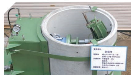
変位量(屈曲角1°かつ外側60mm)に移動し、外水圧0.10MPaを保持する。
